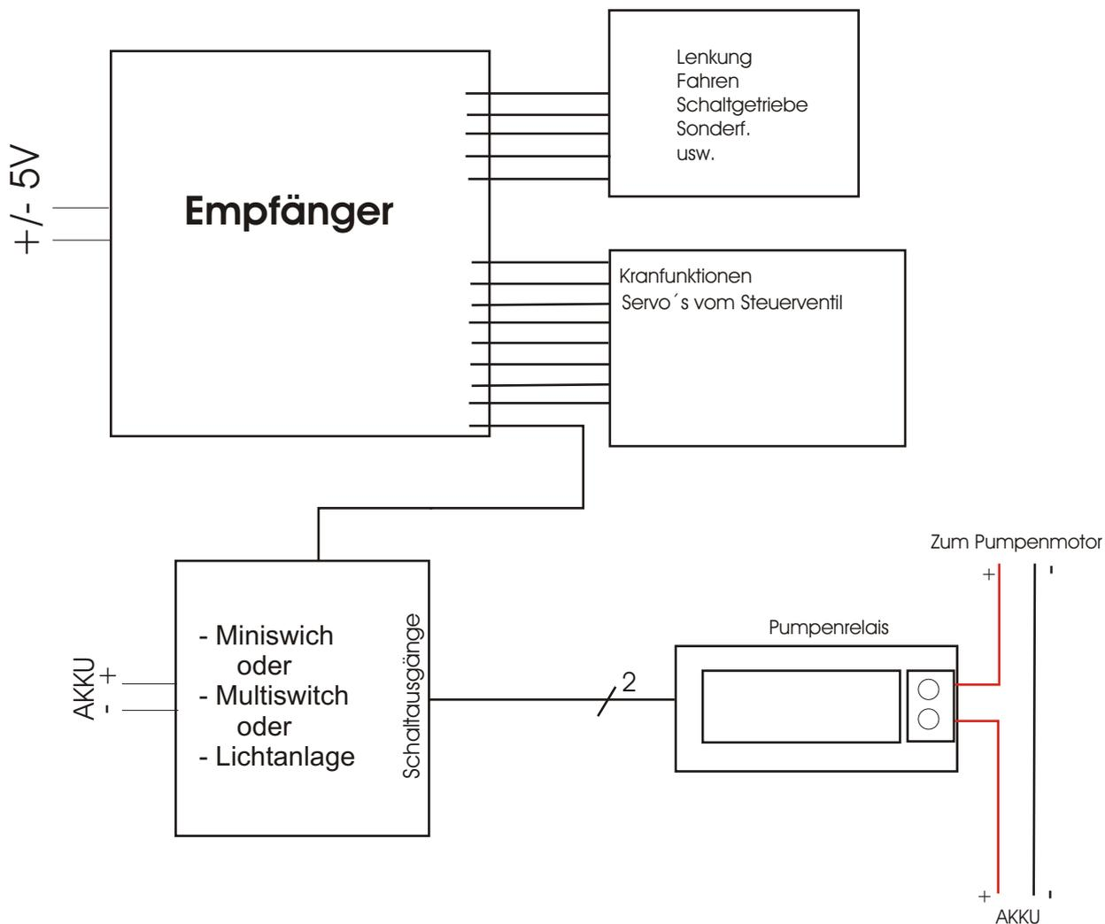
Moderne Fernsteuerungen haben in der Regel ausreichend viele Kanäle, so daß kein Steuerkanal-Umschaltbaustein benötigt wird, um die vorhandenen Kanäle zwischen Fahrbetrieb und Kranbetrieb umzuschalten. So werden also alle Servos des Steuerventils zur Betätigung der Hydraulikfunktionen einfach an den Empfänger angeschlossen.
