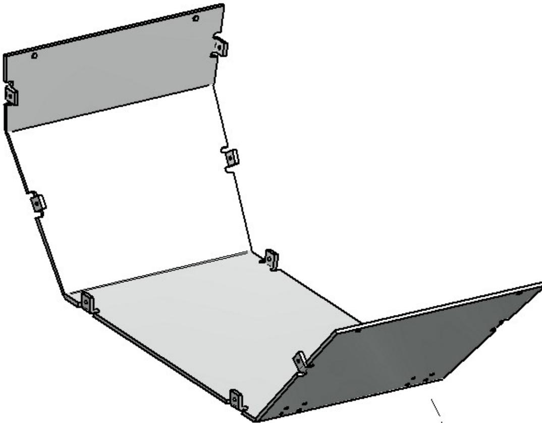
Montieren Sie nun die vorbereiteten Muldenverriegelungen(A) mit je vier Schrauben DIN7985 M2x4 (1) am Bodenblech der Mulde
