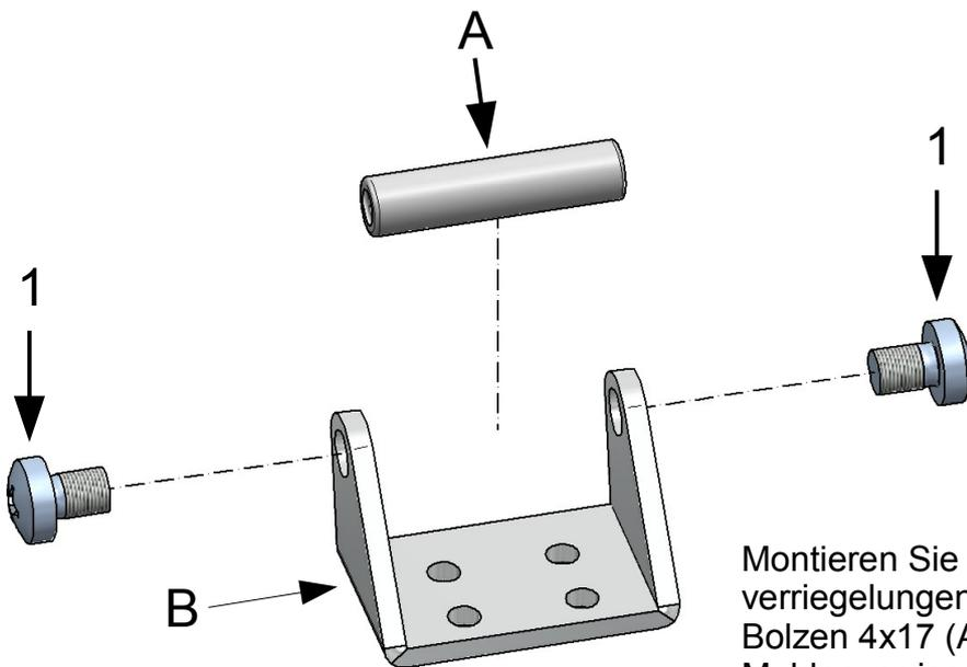
Montieren Sie bitte zunächst die Muldenverriegelungen. Setzen Sie dazu einen Bolzen 4x17 (A) zwischen die Schenkel der Muldenverriegelung (B) und verschrauben Sie ihn mit zwei Schrauben DIN7985 M3x4 (1)
