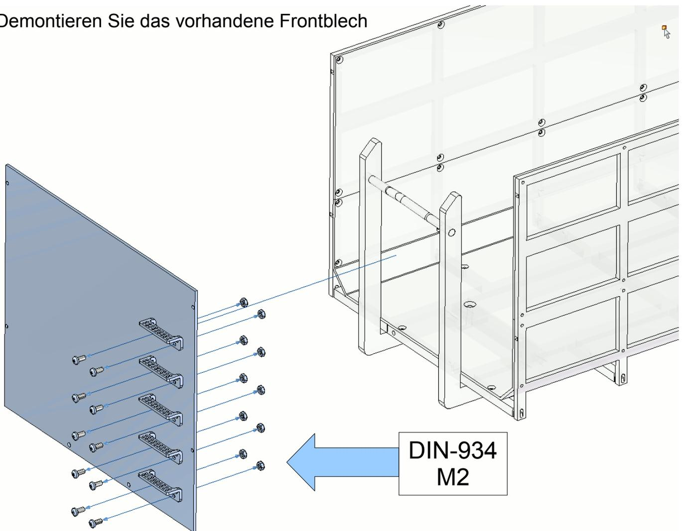
2.) montieren Sie die Trittstufen an das neue Frontblech
