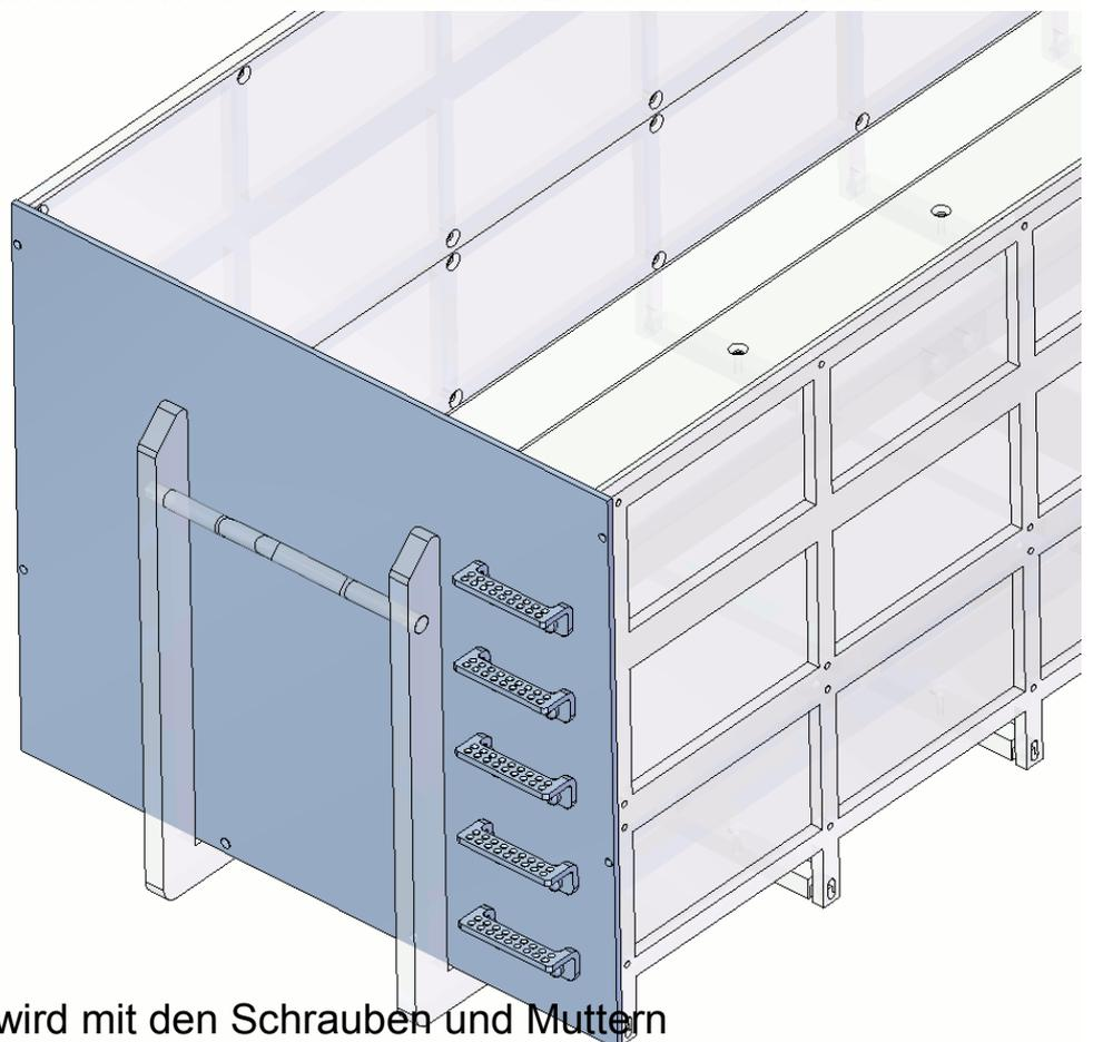
3.) das neue Frontblech wird mit den Schrauben und Muttern ursprünglichen Frontbleches am Abrollcontainer montiert.
