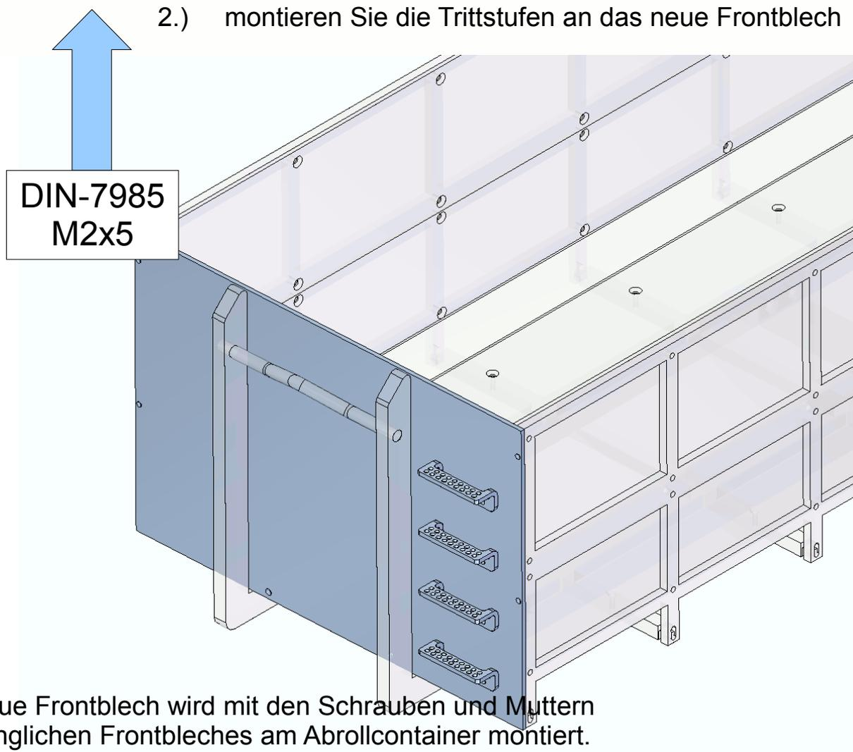
3.) das neue Frontblech wird mit den Schrauben und Muttern ursprünglichen Frontbleches am Abrollcontainer montiert.
