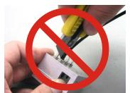
Bitte schneiden Sie den Schlauch auf keinen Fall in Längsrichtung mit einem Messer an.
