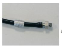
Dann wird der Schlauch etwa 1/2 bis2/3 auf den Nippel geschoben.
