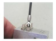
Ziehen Sie zum lösen einer Schlauchverbindung zunächst die Sicherungshülse von dem Anschlußnippel herunter.
